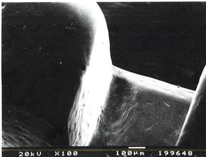
Resim 6. Sinterleme ile üretilmiş brakelerin (Unitek Mini Twin) SEM görüntüleri. 100 büyütmede bile oluk kenarlarındaki bitiş son derece düzgün görünmektedir.
