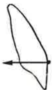
Şekil 1.1. Kuvvet vektörel bir büyüklüktür. Kesici üzerine uygulanan kuvvetin şiddeti okun uzunluğu kadar, uygulama noktası kuronun üzeri, doğrultusu yatay ve yönü önden arkaya doğrudur.
